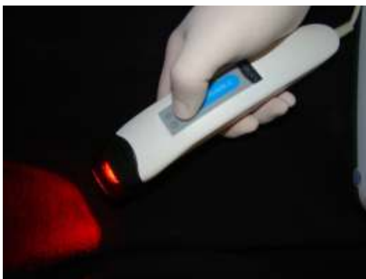
Fig 7: Ponteira de Tratamento para a terapia fotodinâmica constituída por LEDs em torno de 627nm.
