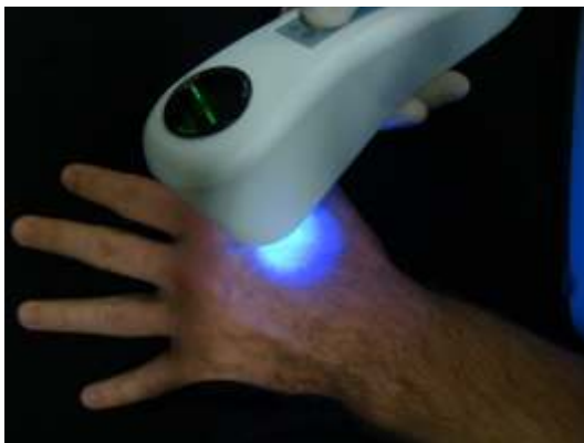
Fig 6: Ponteira de diagnóstico óptico. Observa-se o brilho azul em torno de 405 nm.
