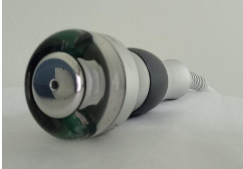
FIGURA 2.4 – Peça de mão da terapia conjugada, possui uma região metálica que corresponde ao transdutor do ultrassom e um orifício central de saída dos Lasers (Fonte: Banco de imagem do autor).
