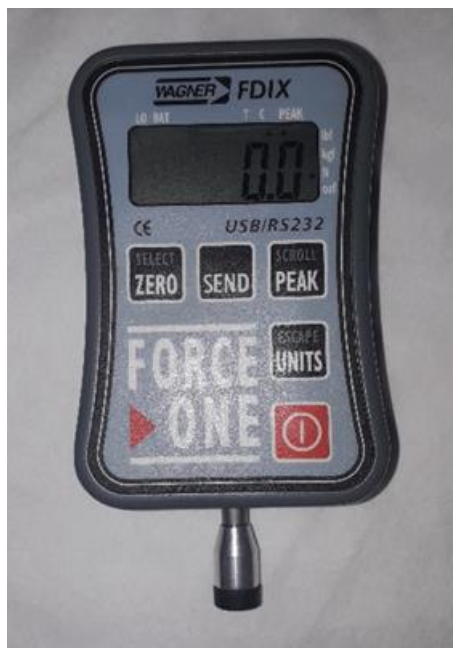
FIGURA 2.2. Algômetro Digital (Fonte: Banco de imagem do autor)
