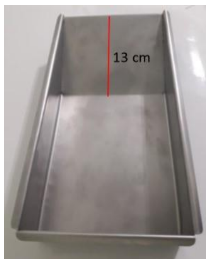
FIGURA 2.9 - Medida da inclinação interna do protótipo da cuba metálica (Fonte: Banco de imagem do autor)
